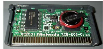
Une cartouche GBA démontée : une ROM à gauche et une RAM avec sa pile de sauvegarde à droite.
